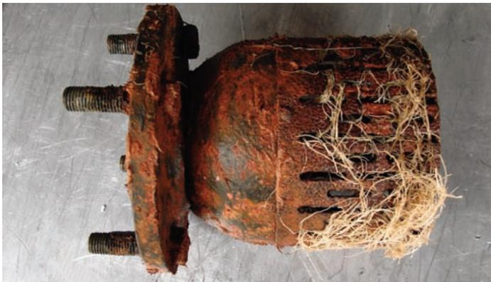
Abb. 19: So nicht! Rostiges und mit Wurzelwerk durchwachsendes Ablaufrohr,
