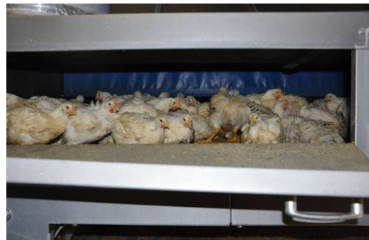
Abb. 3. Förderband vor der Gasbetäubung. Eine Kontrolle der Tiere ist durch Öffnen der Verkleidungsklappe noch möglich.
