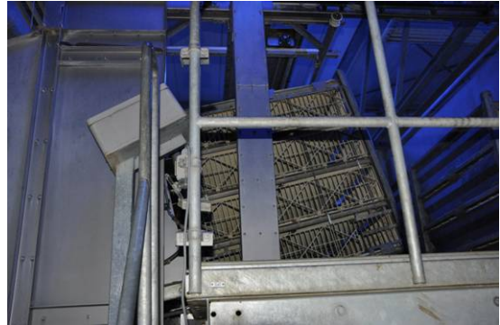
Abb. 2. Automatisches Abladen der Schlachttiere auf ein horizontales Förderband.
